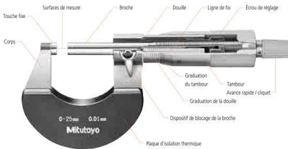
Fig I.5 – Micromètre d’extérieur analogique standard.
